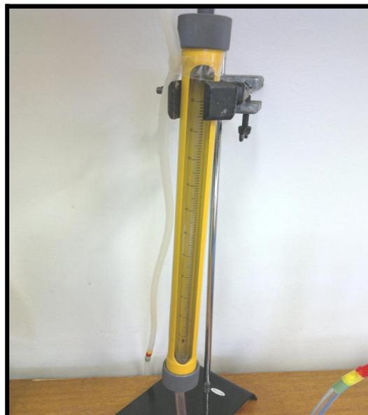
Fig. 4 - Foto ilustrativa do fluxômetro
