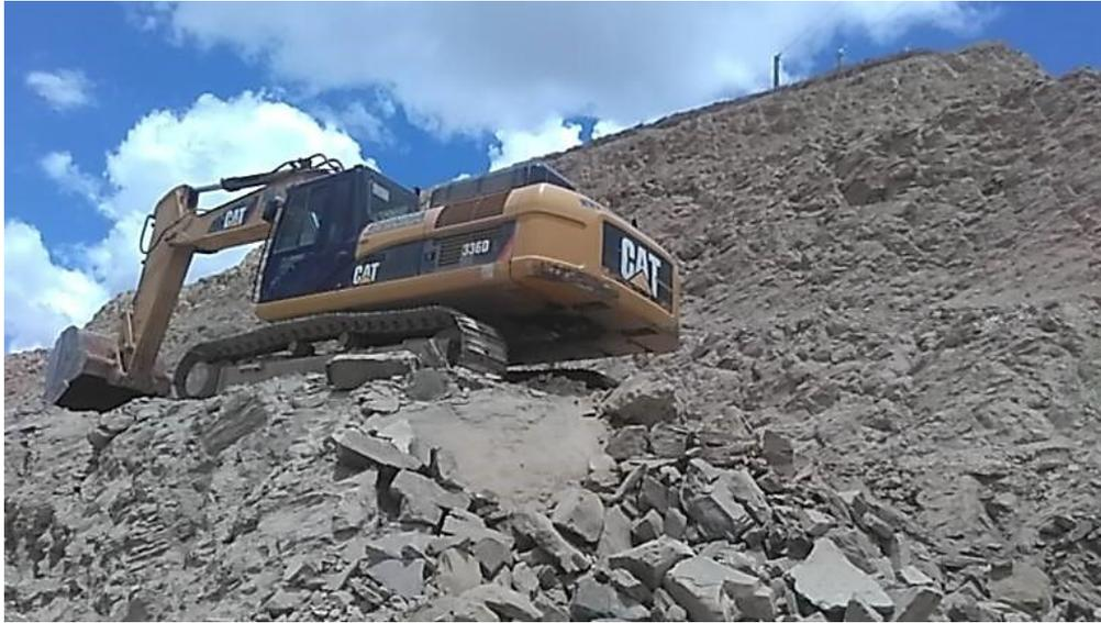
Figura 4 - Extração e desmonte do material pela retroescavadeira.
